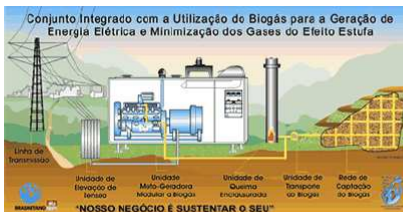
Figura 3: Sistema integrado de captação e conversão do biogás em energia
